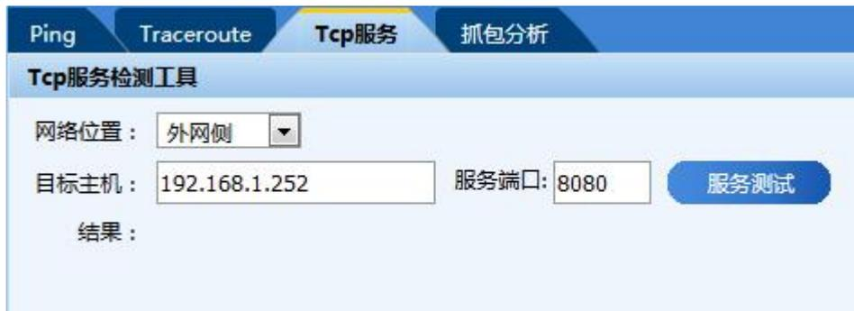
图(74) TCP 端口联通测试
